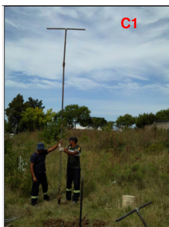
METODOLOGIA DE EXCAVACION: PALA AMERICANA
